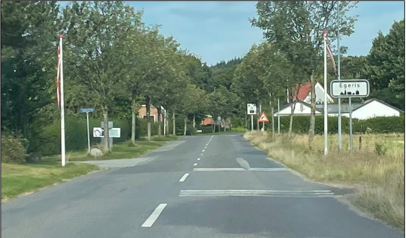
Figur 18. Hastighedsdæmpning med rumlefelter og fartviser ved sydlig bygrænse til Egeris
